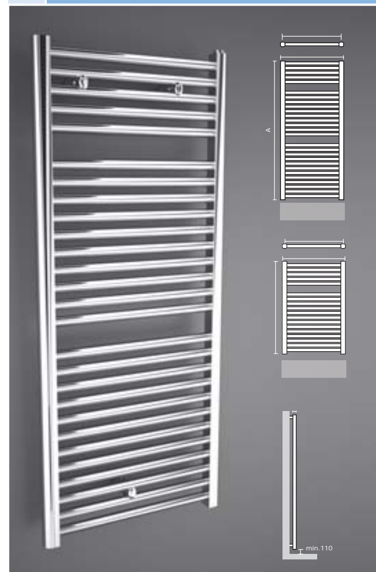
Imagen del secatoallas de 1180 H. con 27 tubos radiantes de ø 25 mm en cromado.
